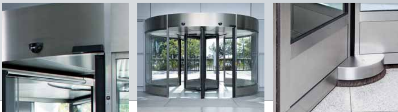
FLUGHAFEN MÜNSTER-OSNABRÜCK | GREVEN | Großraumkarusselltür GGR | vollautomatisch | 3-flügelig | edelstahlbeplankt | Flügel ausschwenkbar für Flucht- und Rettungswege | ø 4800 mm
